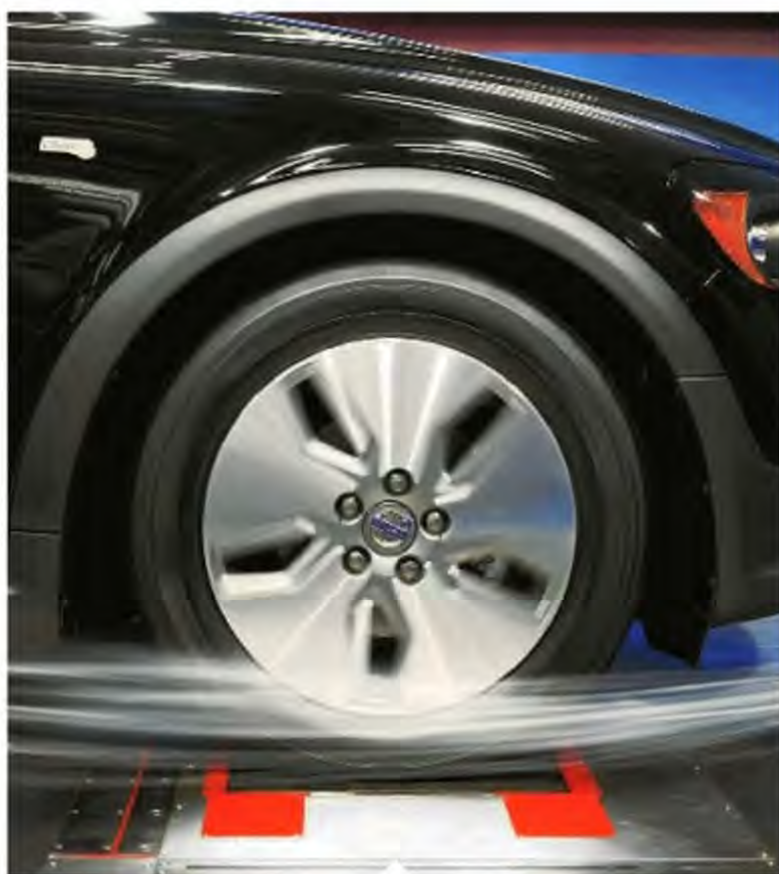
La soufflerie du constructeur Volvo permet de tester l'aérodynamisme des roues dans des flux d'air à 250 km/h.
